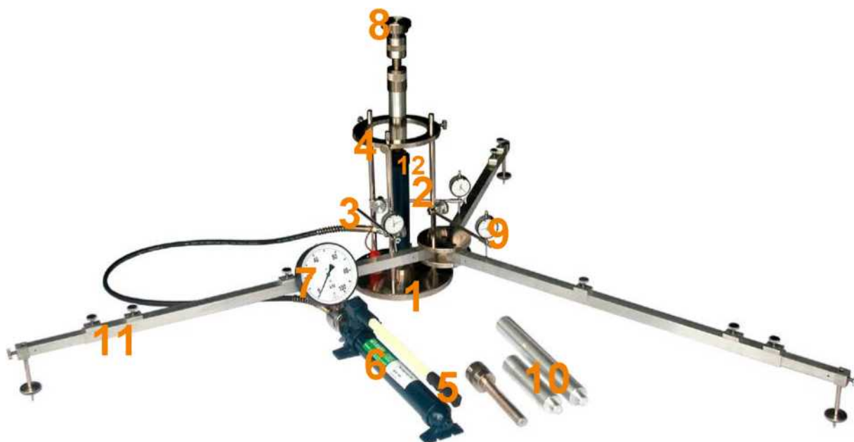
Rys. 1.1. Aparatura VSS z trzypunktowym pomiarem przemieszczenia płyty
