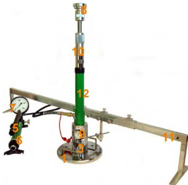
Rys. 1.2 Aparatura VSS z jednopunktowym pomiarem przemieszczenia płyty
